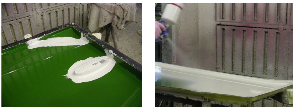
Obr. 12 – Nanášení Gelcoatu ručně (vlevo) a stříkáním (vpravo)[7]
